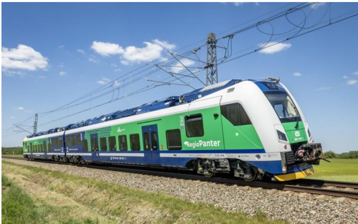
Obrázek 2 - Akutrolejová elektrická jednotka (BEMU) společnosti ŠKODA TRANSPORTATION a.s.; ilustrační foto
