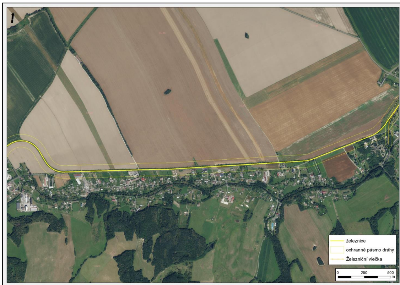
Obrázek 18: Železniční trať – Vidnava- Velká Kraš s vyznačením ochranného pásma
