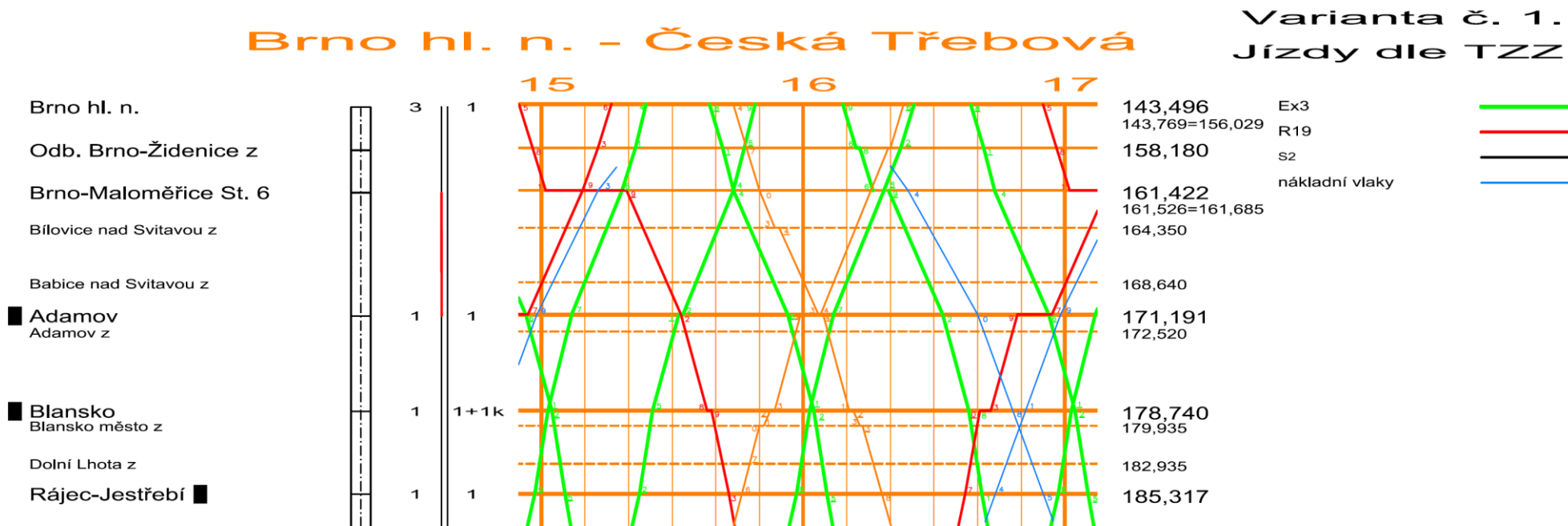
Obrázek 3 Odpolední špička s modelovým GVD se zohledněním výlukových jízdních dob, varianta č.1 , jízdy dle TZZ pro SP1.
